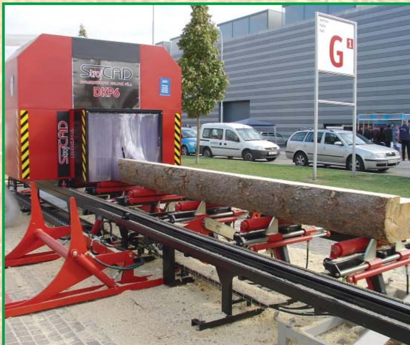
La scie DKP 6 à deux lames perpendiculaires permet de scier simultanément dans le sens horizontal et dans le sens vertical, aussi bien en avançant qu'en reculant, augmentant ainsi la capacité de sciage. Elle convient parfaitement pour le sciage de bois de charpente, planches, lattes, poutres ...
