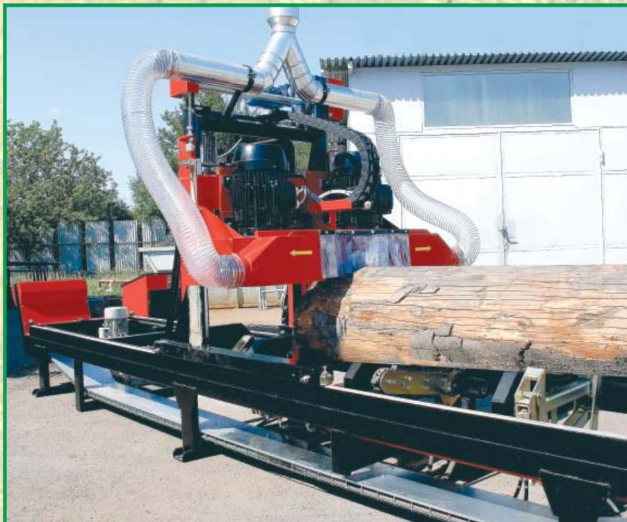
Cette scie est idéale pour la production du bois de charpente ou de plots. Elle est composée de deux scies circulaires horizontales sur un même plan. Le réglage de l'épaisseur de coupe est géré par une division électronique.
