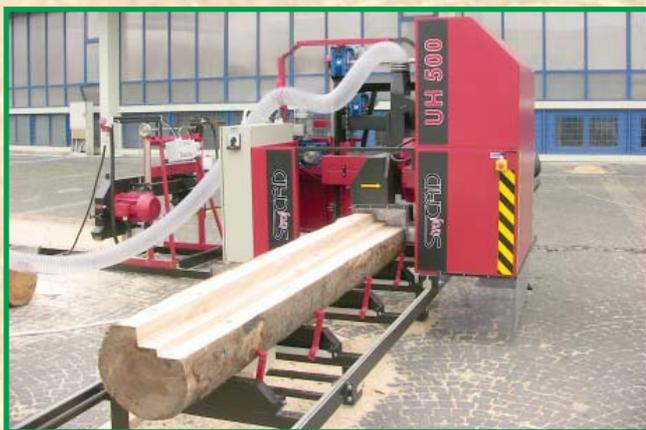
La scie à grumes UH 500 possède une scie circulaire basculante pour le sciage horizontal et vertical. Elle est équipée d'une division électronique OMRON. Son prix avantageux, son faible coût d'utilisation et son rendement garantissent un retour sur investissement rapide.
