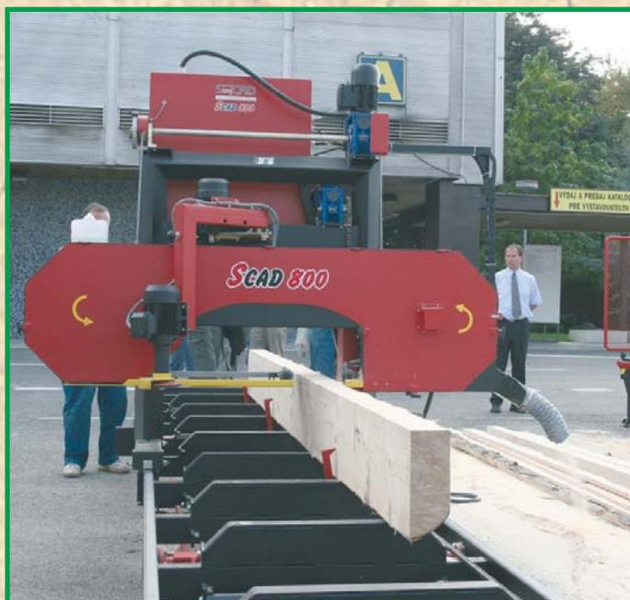
SCAD 800 est une scie à ruban pour utilisation professionnelle. Elle a un bâti massif stable. La tension de la lame est hydraulique avec indicateur de tension.
