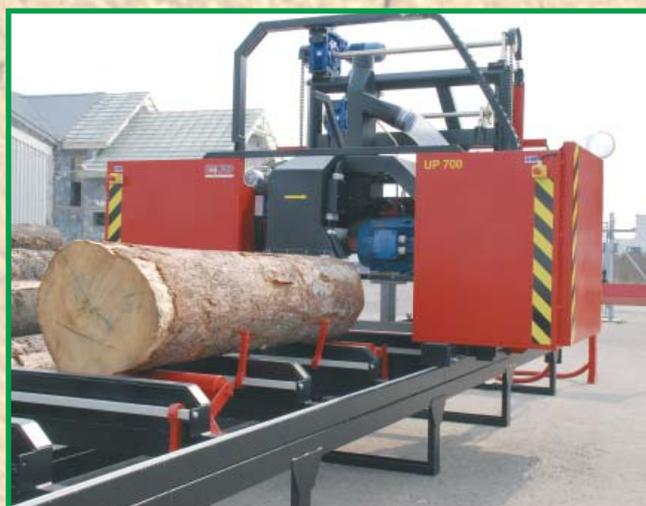
La scie UP 700, de construction identique à la scie plus petite UH 500, est prévue pour le sciage de troncs plus gros. Le principe de travail et les avantages de la machine sont identiques à la scie UH 500.
